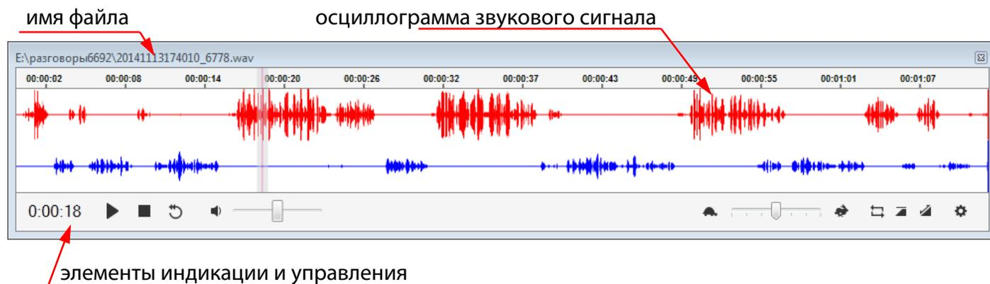
Рисунок 48 – Плеер с осциллограммой
