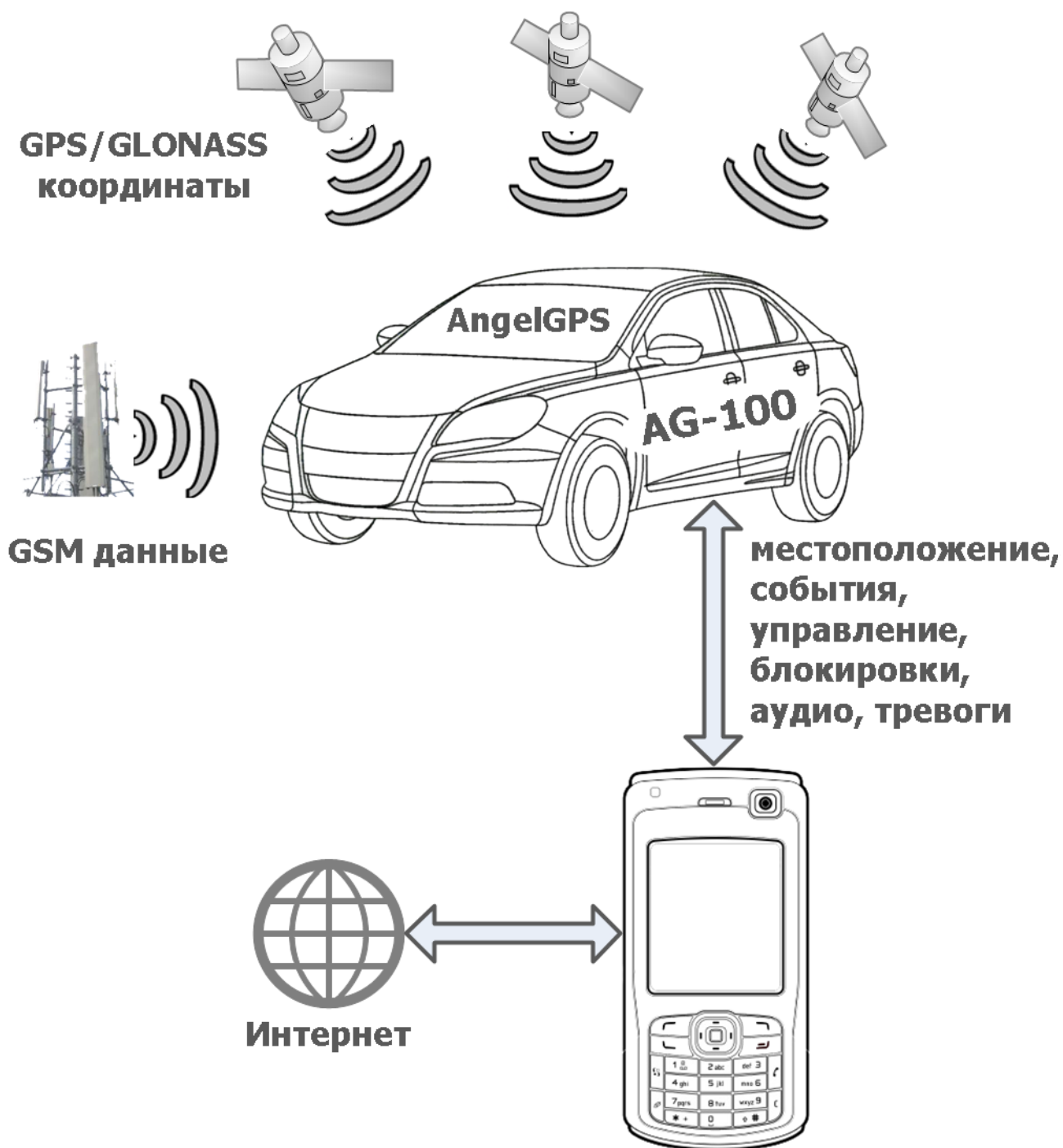
Рис.1 Принцип работы устройства.
