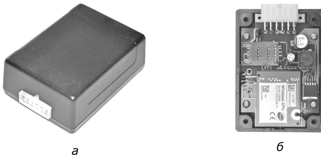
Рис.2 Общий вид устройства спутникового мониторинга AngelGPS AG-100: а) в корпусе, б) со снятой крышкой
